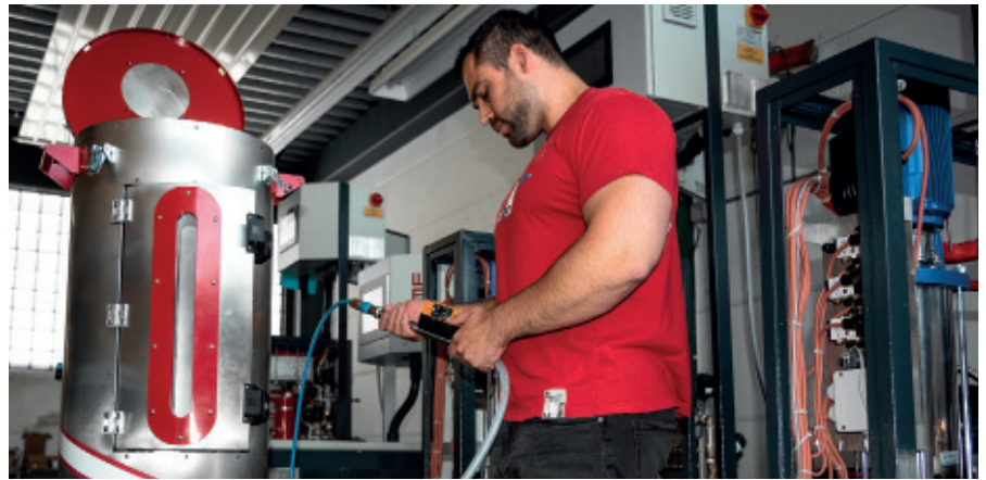
Die neuen Granulattrockner, eine gemeinsame Entwicklung von QIP und Wenz, arbeiten schneller und energieeffizienter als bisherige Systeme. Bild: QIP
